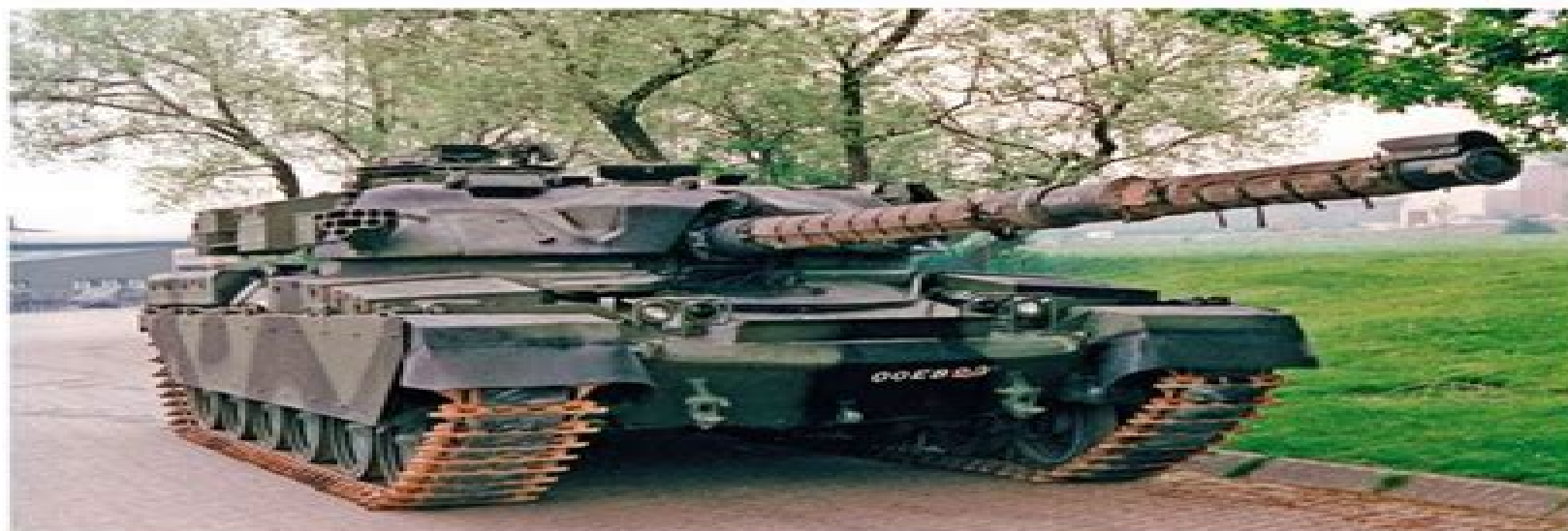
Der Kampfpanzer Chieftain löste ab dem Jahre 1967 die bisher in den Panzerregimenten der Britischen Rheinarmee verwendeten Kampfpanzer vom Typ Centurion ab. Hier zu sehen ein Chieftain Mk. 11 im Jahre 1991 in Paderborn. Auf dem Bild ist die Stillburn-Zusatzpanzerung am Turm gut zu erkennen. The Chieftain MBT replaced the Centurion within armoured regiments of the British Army of the Rhine from 1967. Shown here is a Chieftain Mk. 11, pictured in Paderborn, Germany in 1991. The tank's Stillburn armour is visible here. (19)
