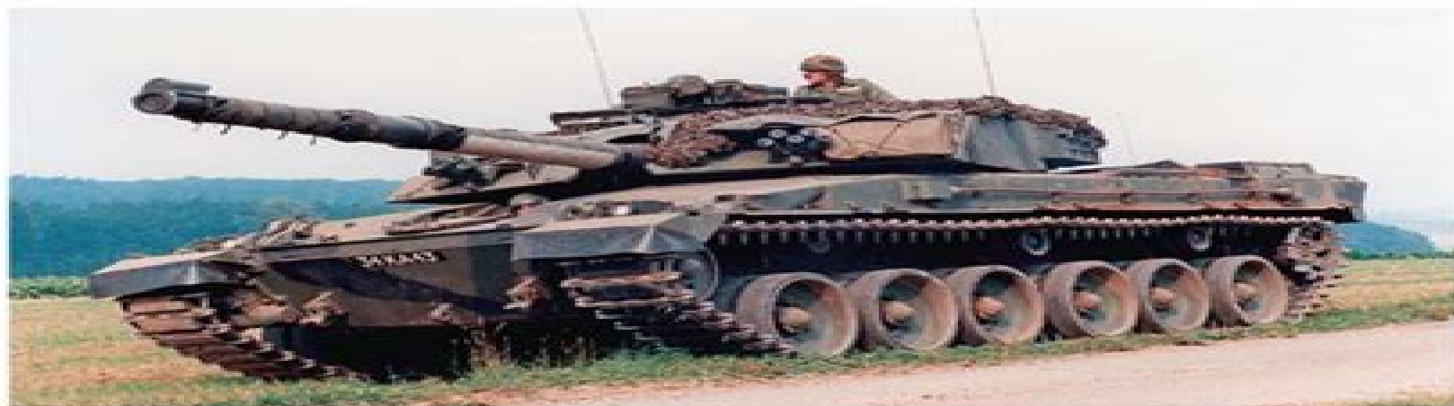
Ein Kampfpanzer Challenger 1 des 3rd Royal Tank Regiment während einer Übung im Herbst 1989 im Raum Aachen in Nordhessen. Das abgebildete Fahrzeug hat keine Kettenblenden. Der Challenger 1 hat ein Gefechts-gewicht von 62 t und ist mit einer 120 mm Borellkanone L115, zwei MG 7,62 mm und einer Nebelmittelwerfanlage mit acht Töpfen bewaffnet. A Challenger 1 MBT of the 3rd Royal Tank Regiment during an exercise in the autumn of 1989 around Aachen in Northern Hesse. The shown vehicle has no side skirts fitted. The Challenger 1 has a combat weight of 62 tonnes and it is armed with a 120mm L115 main gun, two 7.62mm machine guns and a smoke grenade discharger array with eight tubes. (18)
